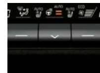
ステアリングヒータースイッチ
